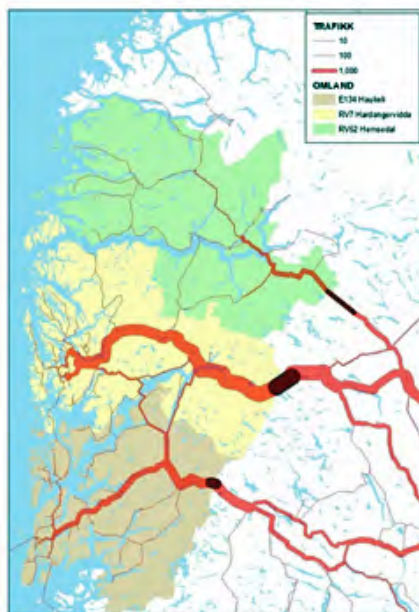
Figur 35: Med Nullkonseptet og Basis2050 som referansesituasjon får rv. 7 over Hardangervidda betydelig trafikkvekst på bekostning av rv. 52 over Hemsedalfjellet
