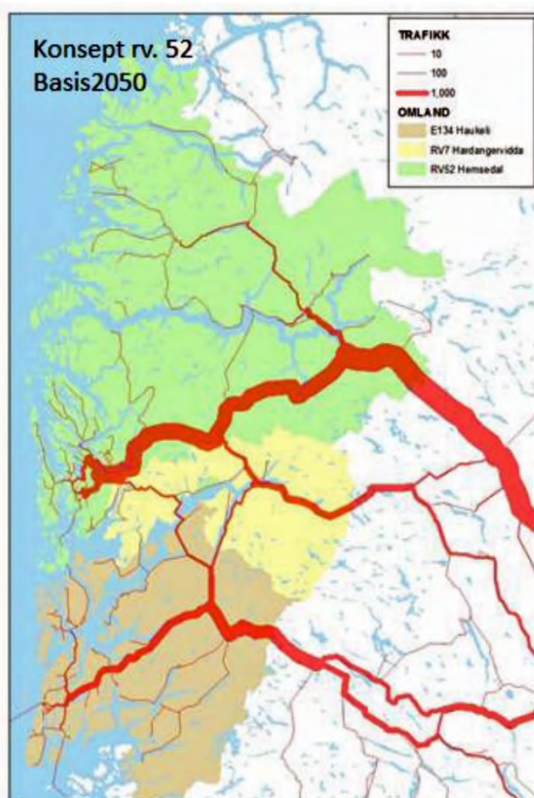
Figur 42: Trafikfordeling på fjellovergangene med Konsept rv. 52 lang tunnel i de tre fremtidsscenariene Basis2050 og Pluss2050
